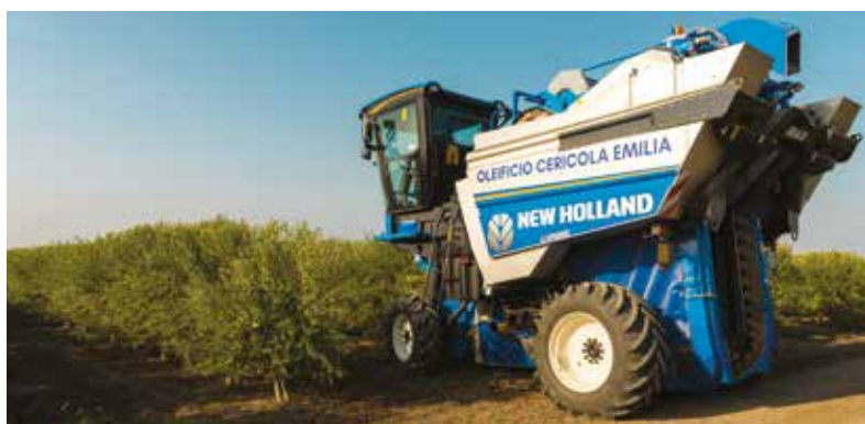
Macchina scavallatrice New Holland 9090X OLIVE, in oliveto ad alta densità
